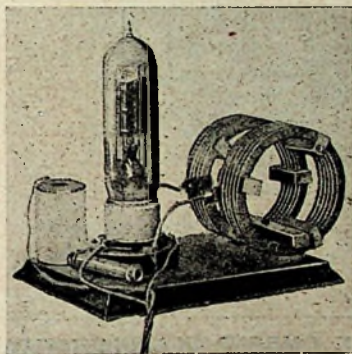
De 20-meter-zender met rooster- en plaatspoel, smoorspoel en roosterlek
